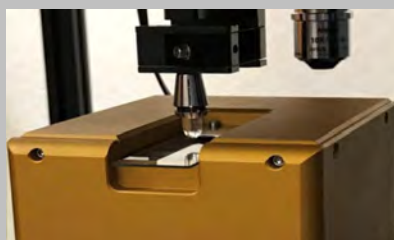
Испытание контакта гидрогеля на стекле с покрытием. Анализ области контакта в реальном времени в зависимости от силы прижима.
