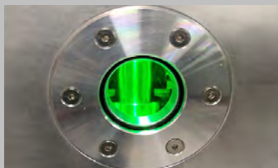
Вакуумная камера со встроенным рамановским и профилирующим рамановским спектрометром для анализа состава следа износа
