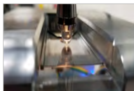
Гидрогели - изменение площади контакта в зависимости от силы
