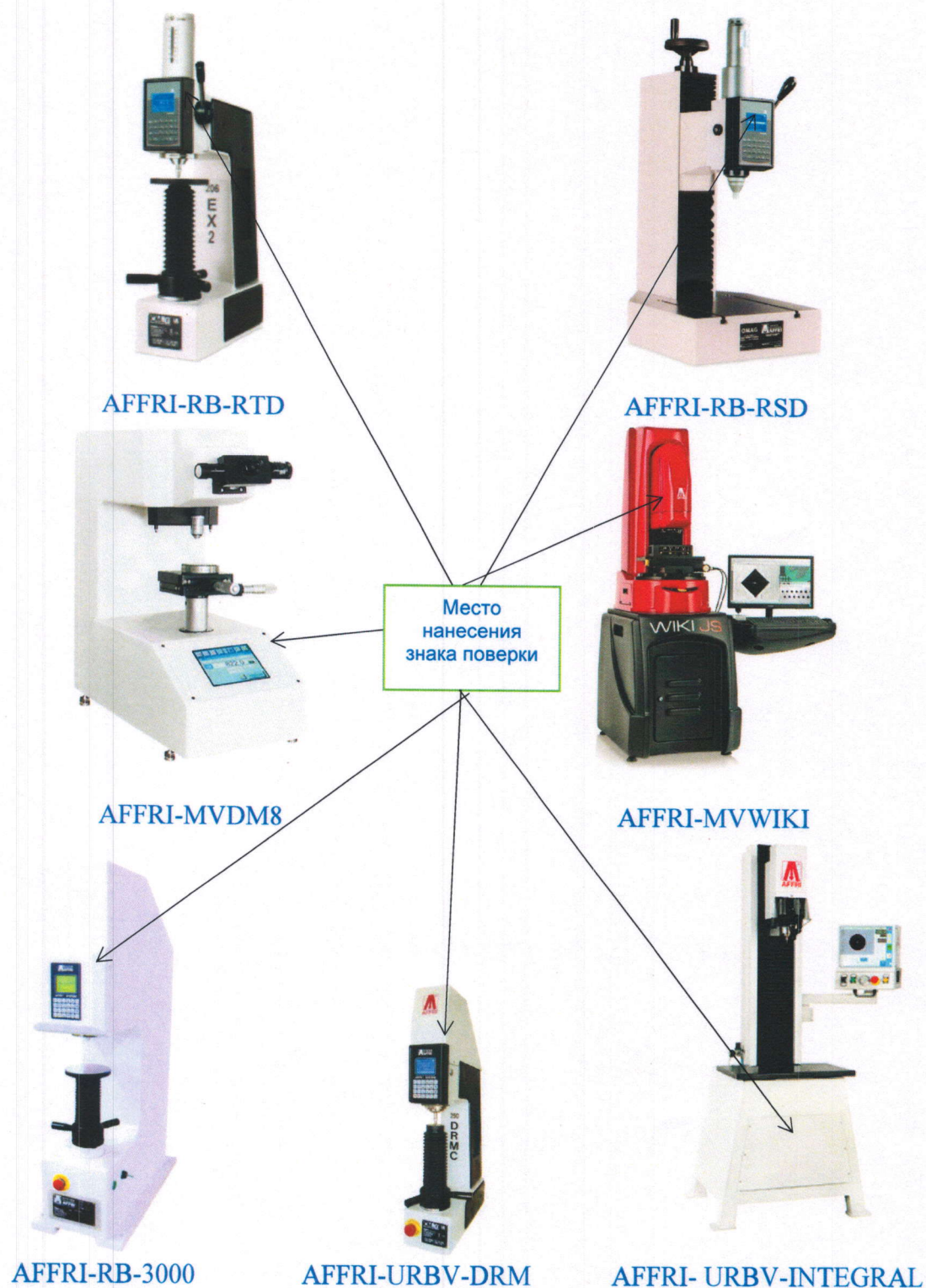
Рисунок 2 – Место нанесения знака поверки средств измерений
