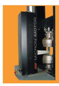
Основные черты универсальных испытательных машины Quasar это: Чрезвычайно высокое разрешение по силе и считыванию перемещений.
