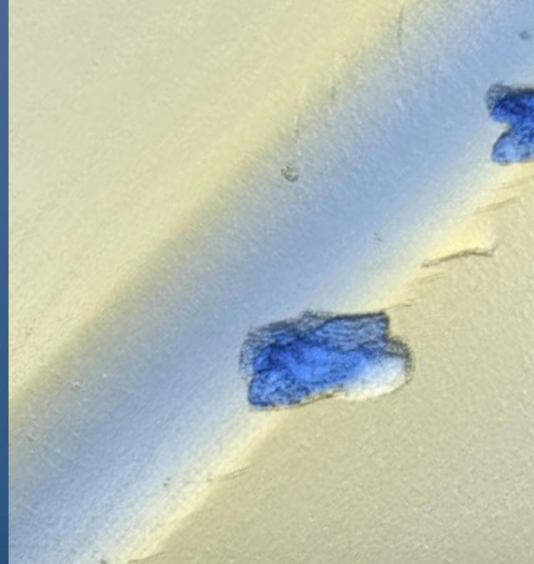
После нанесения царапины снимаются изображения всей царапины, чтобы предоставить пользователю полную информацию о следе износа, ширине и глубине царапины, распространении трещин, типах разрушения покрытия, шероховатости, удаленном объеме материала и многом другом.
